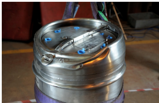
Lid edge damage
