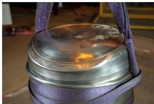
Base edge damage
