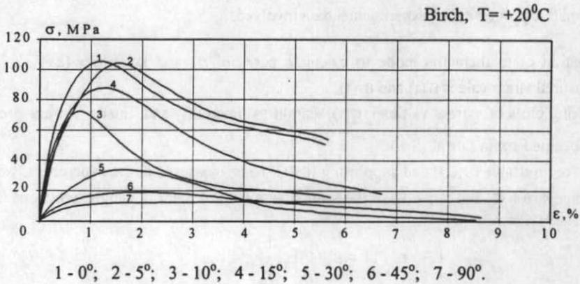
Fig. 3 b. Dynamic « $\sigma$ - $\epsilon$ » diagrams for birch.
